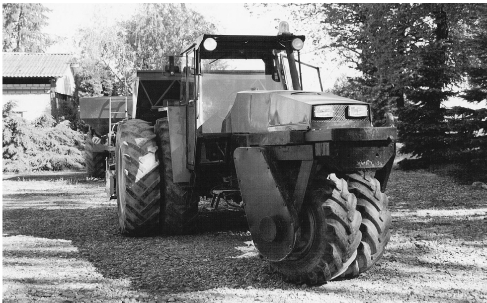
Rys.1. Ciągnik o specjalnej konstrukcji do ugniatania gleby Fig. 1. A special design tractor for soil compaction
